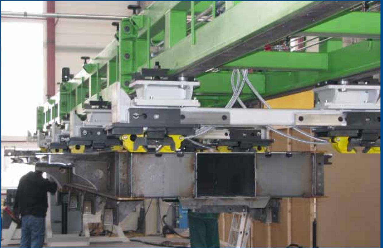
Ausschweißvorrichtung für Trailer-Chassis zum Ausschweißen oder zur Endmontage
